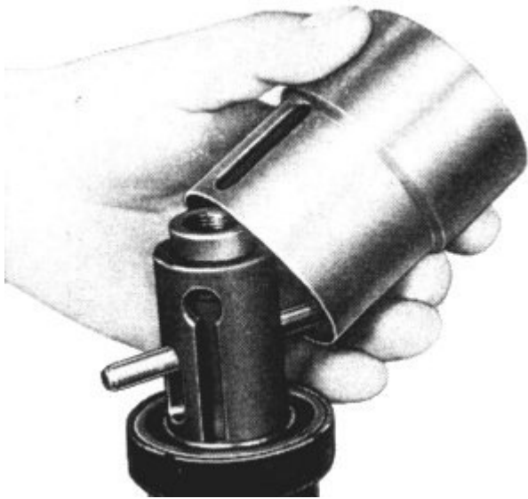
Bild 101. Oberteil der AbziehVorrichtung aufsetzen
